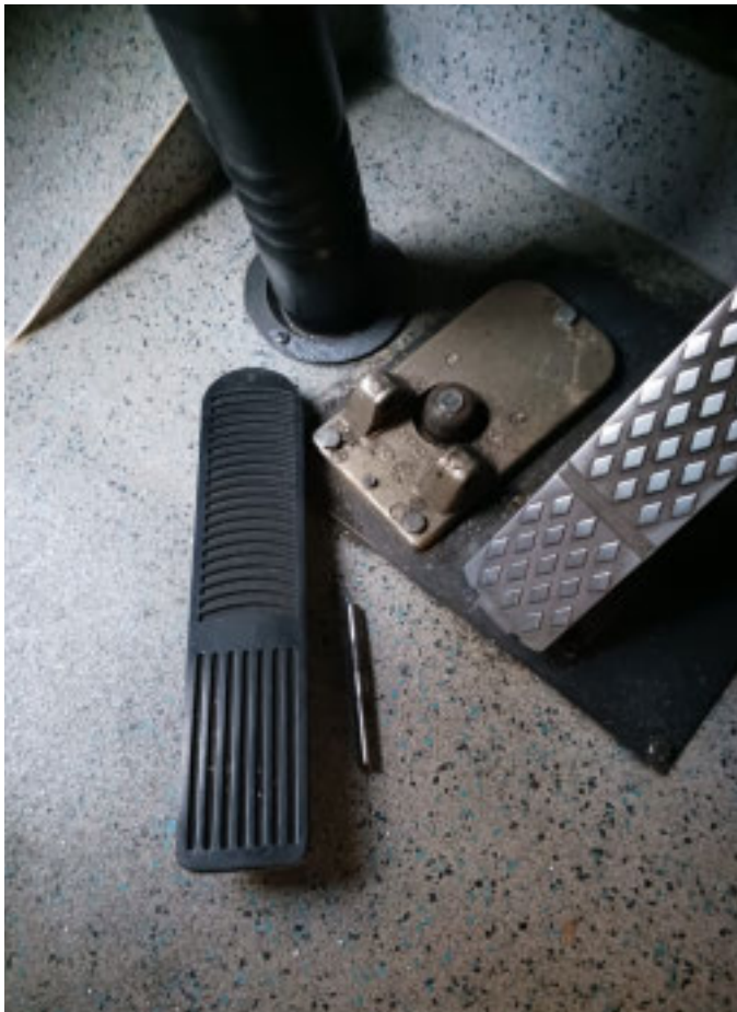
IMMAGINE CHOC Il pedale del freno che si è staccato
